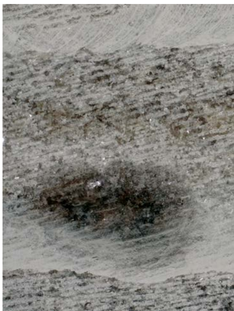
Рис. 1 – Субгоризонтальный влагонасыщенный галопеллитовый флюидоканал в толще чистой каменной соли верхнебельской свиты на глубине 600 м. Тыретский солерудник 2017. Фото автора.
