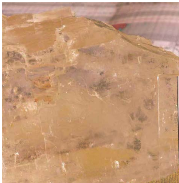
Рис. 2 – Монокристалл NaCl с газожидкостными включениями (продолговатые пузырьки). Тыретский солерудник 2017. Фото автора.
